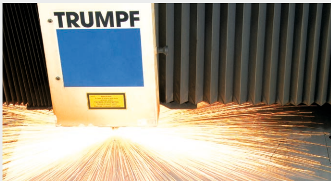
↑ Jedes Konstruktionsteil der Maschine wird – ausgehend vom 3D-Modell – mit Lasergeräten ausgeschnitten und dann abschließend bearbeitet.
