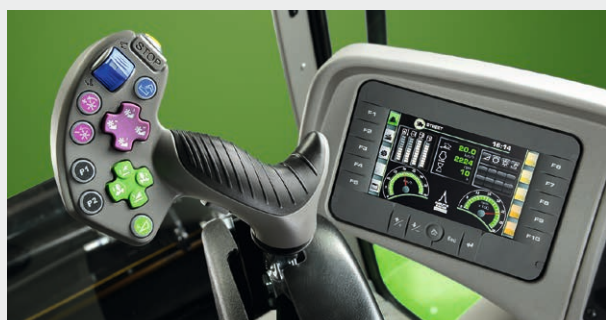
↑ COMMANDER STICK. Zur Steuerung von: 1) Position und Neigung des Schneidwerks
