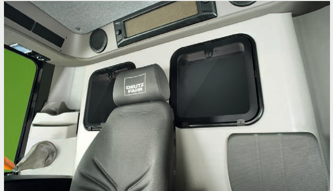
↑ Sichtkontrolle des Korntanks. Ein Doppelfenster gestattet die Sichtkontrolle des Füllstands und der Kornqualität von der Kabine aus.
