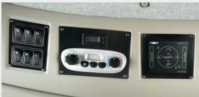
↑ Das Balance-System ermöglicht den Neigungsantrieb der gesamten Maschine bis zu 20 % in seitlicher und bis zu 6 % in Fahrtrichtung. Dabei wird der gesamte Mähdrescher automatisch immer in der Horizontalen gehalten.
