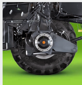
↑ Sowohl die Balance- als auch die Standardachsen haben Untersetzungsgetriebe mit einer Kapazität von 25 Tonnen, die es auch unter erschwerten Bedingungen ermöglichen, mit maximaler Sicherheit zu arbeiten.
