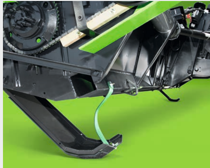
↑ Durch die Tastkufen wird das Schneidwerk optimal am Boden geführt.
