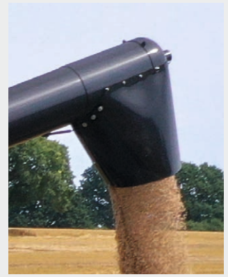
↑ Kornauslauf, schnelle und effiziente Obenentleerung.
