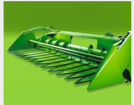
↑ Der Sonnenblumenvorsatz ermöglicht die Ernte der Sonnenblumenkörbe und optimiert dadurch die Dreschleistung.
