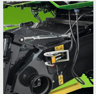
↑ Die Schnittwinkelverstellung ermöglicht eine perfekte Anpassung an Bodenunebenheiten.
