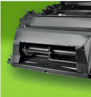
↑ Die Breite des Förderkanals schränkt das Dreschsystem auch bei großen Getreidemengen nicht ein.
