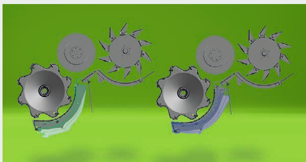
↑ DRESCHKORBEINSTELLUNG. Die Abstände zwischen dem Dreschkorb und der Dreschtrommel am Ein- und Ausgang können unabhängig voneinander im vorderen und hinteren Bereich über Elektromotoren eingestellt werden, die über das Commander Control System gesteuert werden.
