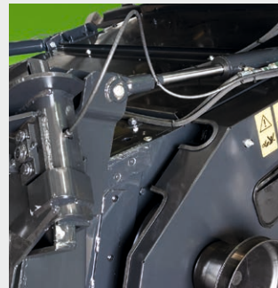
↑ Die Schnittwinkelverstellung ermöglicht eine perfekte Anpassung an Bodenunebenheiten.
