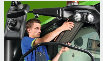
↑ Die Kabinenluftfilter lassen sich leicht und ohne den Einsatz von Werkzeug austauschen.
