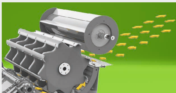
↑ DRESCHTROMMEL, DRESCHKORB UND WENDETROMMEL. Die große Dreschtrommel mit einem Durchmesser von 600 mm und einer Breite von 1,27 m bei 5 Strohschüttlern bzw. 1,52 m bei 6 Strohschüttlern und der segmentierte Dreschkorb mit einem Umschlingungswinkel von 121° stellen unter allen Bedingungen den perfekten Dreschvorgang sicher.
