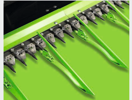
↑ Die wechselweise montierten Mähklingen verringern den Verschleiß und garantieren immer einen optimalen Schnitt.
