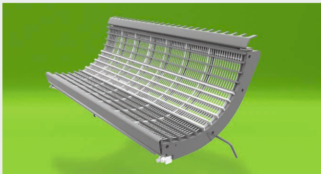
↑ Dreschkorb mit versch. Drahtabständen oder der universelle Segmentkorb.
