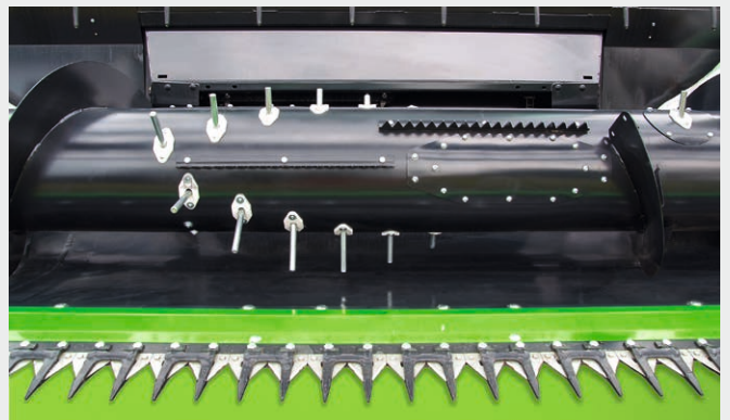
↑ Die Einzugsschnecke mit spiralförmig angeordneten Fingern sorgt für einen gleichmäßigen und konstanten Einzug.
