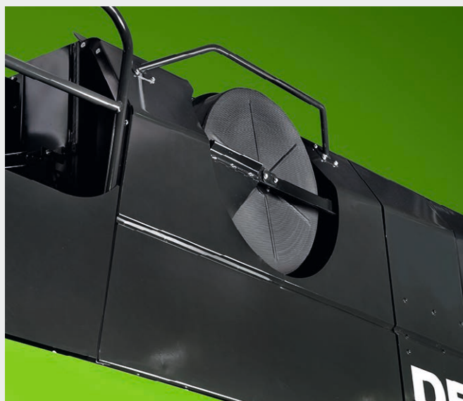
↑ Großer rotierender, selbstreinigender Luftansaugkorb.
