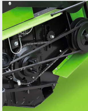
↑ Planetenantrieb für eine hohe Schnittfrequenz.
