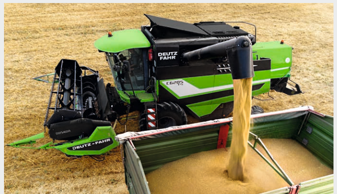
↑ Obenentleerung für höchste Überladehöhen.
