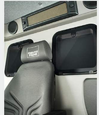
↑ Beidseitige Sichtmöglichkeit in den Korntank.
