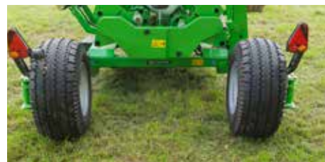
Beim Straßentransport können die Räder nach innen geklappt werden, um die Transportbreite zu verringern. Die hydraulische Klapptsteuerung ist optional
