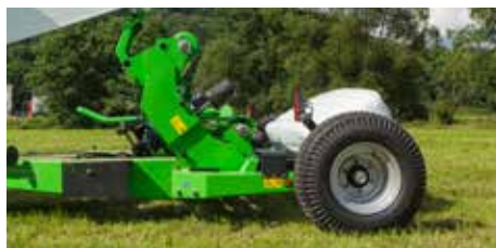
Durch das tiefliegende Fahrgestell lässt sich der Ballen sanft ablegen und ist vor Folienschäden geschützt
