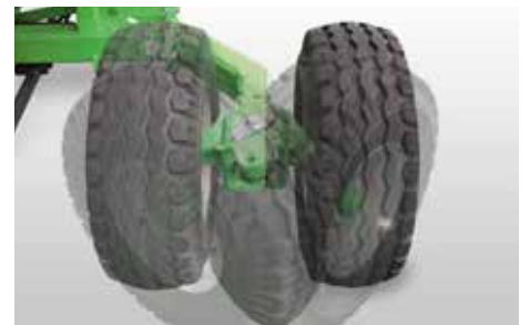
Zum Straßentransport kann das rechte Rad nach innen eingeklappt werden. Einklappung des linken Rades auf Wunsch
