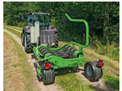
Geringere Transportbreite durch Einklappung eines Rades
