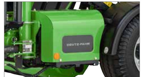
Große Seitenabdeckung zum Schutz der Hydraulikeinheit mit guter Zugänglichkeit bei der Wartung
