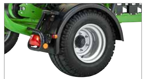
Große Schutzbleche, damit die Folie beim Transport nicht beschädigt wird
