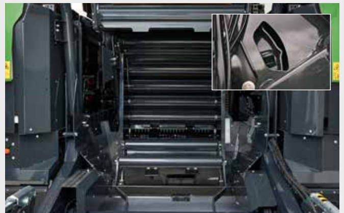
↑ Das Herz der Presse sind 18 POWER TRACK-Walzen, die erstaunlich hohe Pressdichten erzeugen und den Ballen in jeder Lage zuverlässig in Drehung halten. Die integrierten Abstreifer an den Walzen halten das Pressgut aktiv von den Lagern fern.
