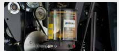
Zentralschmierung mit 4 kg Vorrat
