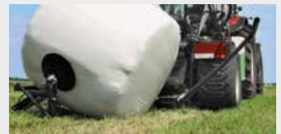
Ballendreher (legt Ballen auf flacher Seite ab)
