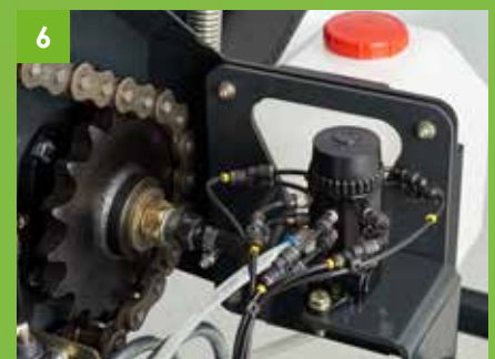
6 Automatische BEKA-MAX Kettenschmierung
