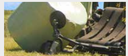
Ballendreher (legt Ballen auf flacher Seite ab)
