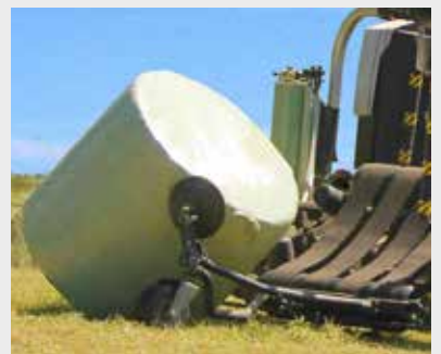
Ballendreher (legt Ballen auf flacher Seite ab)
