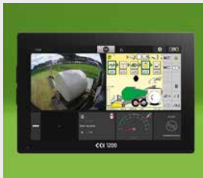
↑ CCI 1200: Innovatives, ultra-leistungsfähiges Panorama-Display Auf dem 12,1-Zoll (30,5 cm) großen Display werden alle wesentlichen Informationen angezeigt. Es sind verschiedene Anzeigeformate möglich: Mini-View / Maxiview / Doppel-UT.
