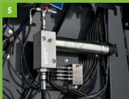
5 Serienmäßige automatische BEKA-MAX Zentralschmierung für die Walzenlager
