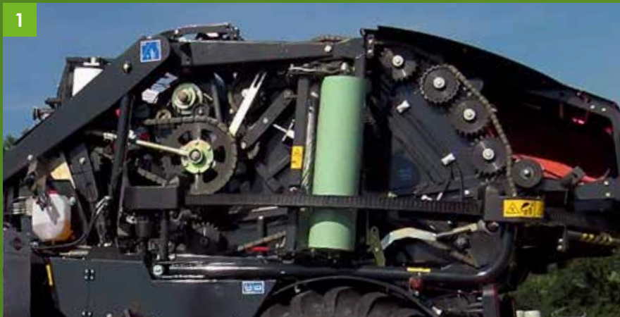
Robuster Antrieb mit hochwertigen IWIS-Ketten
