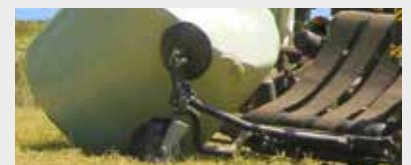
Ballendreher (legt Ballen auf flacher Seite ab)
