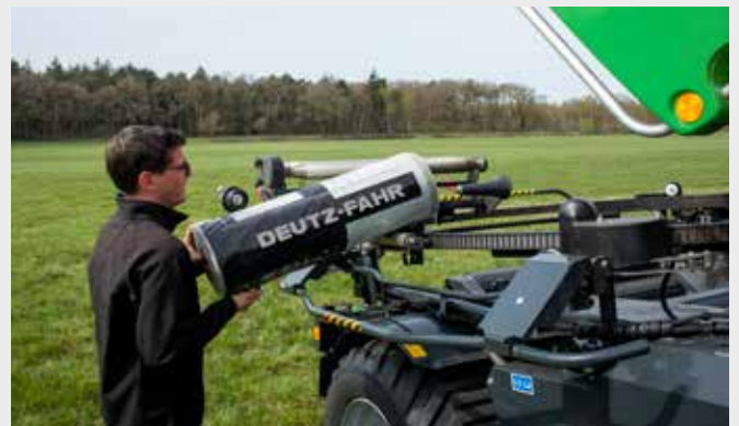
↑ Der Vorstrecke lässt sich über den Wickelring kippen, sodass die Folienrollen leicht auszutauschen sind. Die integrierte Stützrolle schützt die Folie vor Beschädigung und trägt ihr Gewicht, sodass sich die Folienrollen schnell und leicht wechseln lassen.
