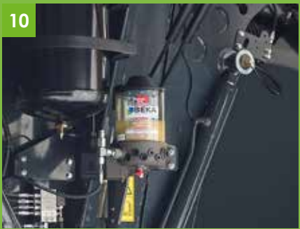
Serienmäßige automatische BEKA-MAX Zentralschmierung
