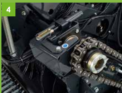
4 Serienmäßige hydraulische Rotorentkopplung
