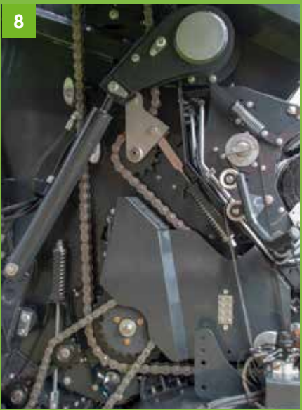
Robuster Antrieb mit verschleißfesten, groß dimensionierten Ketten
