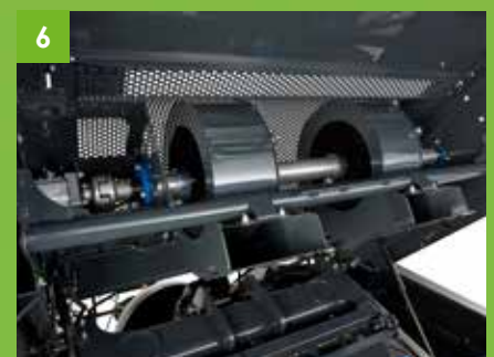
Turbinengebläse für Knoterreinigung
