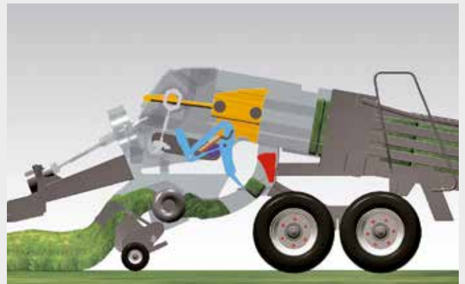
2. Der Raffer (blau) füllt aktiv die Vorkammer.
