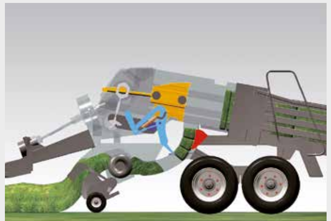
3. Der einfachwirkende Raffer formt Ballenpakete, bis die Sensorplatte (rot) beim voreingestellten Druck weggedrückt wird.
