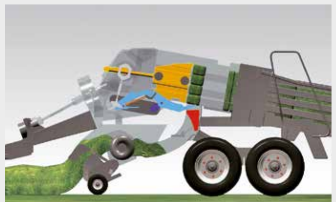
4. Beim Wegdrücken aktiviert die Sensorplatte die zweite Funktion des Raffers. Bei der erneuten Bewegung des Raffers wird die Vorkammer geleert und das perfekt geformte Ballenpaket in die Presskammer geschoben.
