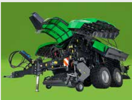
↑ Die Garnkästen lassen sich komplett aufschwenken und legen so die Hauptkomponenten der Maschine frei. 32 Garnrollen von je 13 kg können hinter den weit öffnenden Seitenklappen mitgeführt werden.
