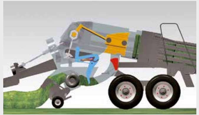
1. Der INTEGRALROTOR befördert das Pressgut aktiv in die Presskammer.
