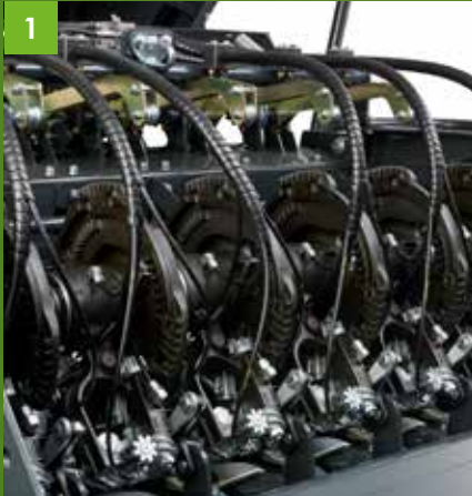
Doppelknotersystem mit serienmäßiger elektronischer Überwachung
