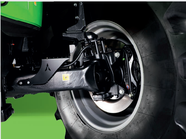
↑ Trockene Scheibenbremsen für maximale Bremsleistung.
