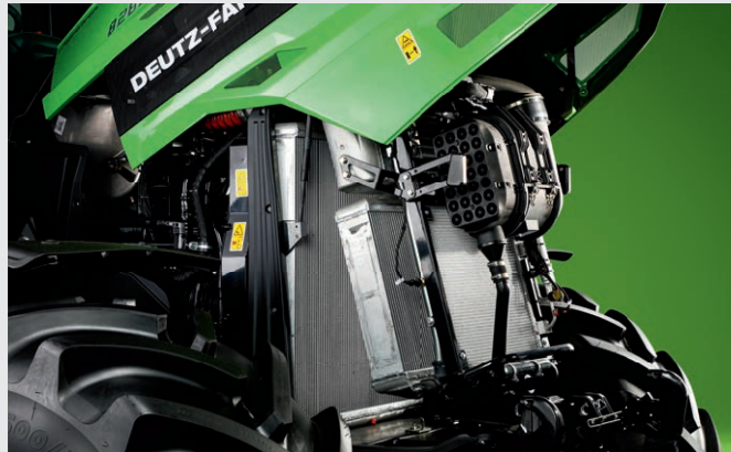
↑ Gut zugänglicher Kühler und Luftfilter.
