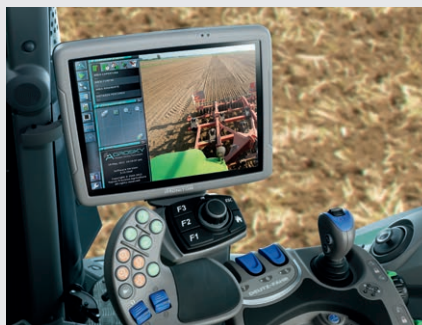
↑ Integrierte Kamera mit automatischem Vollbildmodus (z. B. beim Rückwärtsfahren) für eine bessere Übersicht und mehr Sicherheit.
