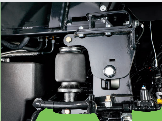
↑ Druckluftgederete Kabine für höchsten Fahrkomfort.
