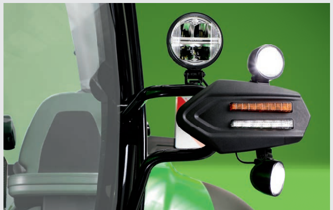
LED-Fahrscheinwerfer für mehr Helligkeit und eine größere Reichweite.
