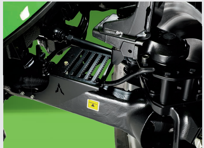
↑ Trittstufen auf der Vorderachse für Wartungs- und Reinigungsarbeiten.
