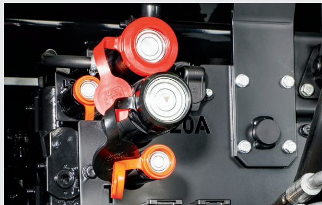
↑ Flachkupplungen für eine saubere Verbindung.
