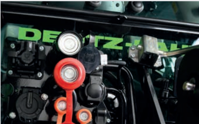
↑ PowerBeyond ist mit Standard- oder Flachkupplungen erhältlich.
