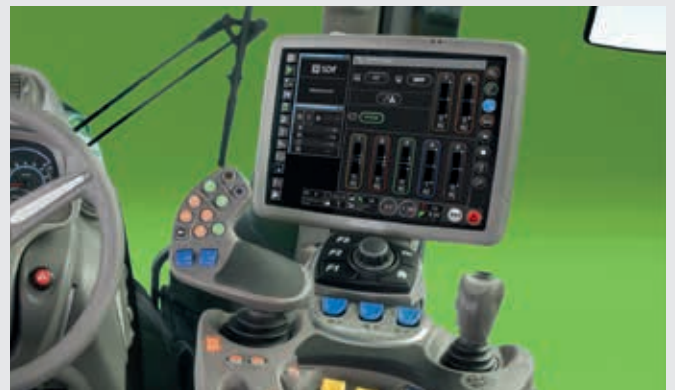
↑ Elektrische Steuerventile mit komfortablen elektronischen Bedienelementen.
