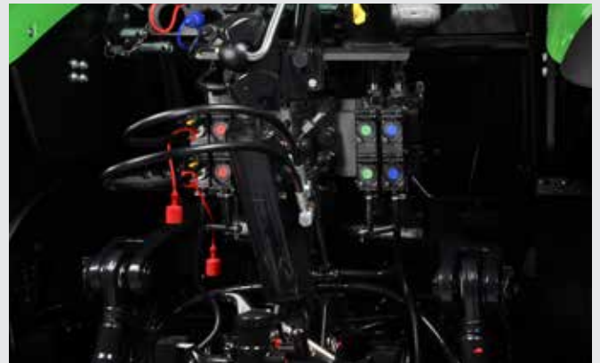
↑ Hoher Komfort kombiniert mit einfacher Bedienung: gemischte hydraulische Konfiguration mit zwei elektrischen und zwei mechanischen Steuerventilen.
