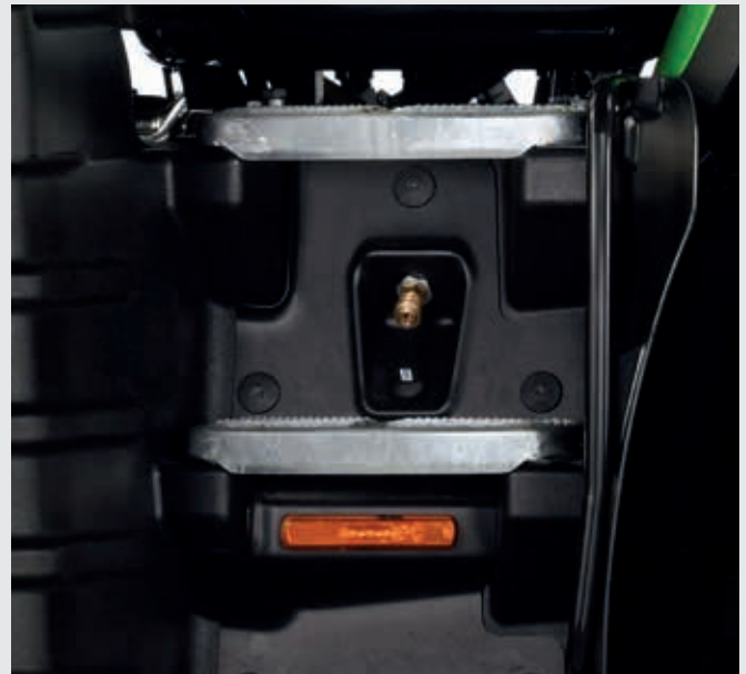
↑ Druckluftanschluss und Aufstiegslichtschalter geschützt unterhalb der Treppe.
