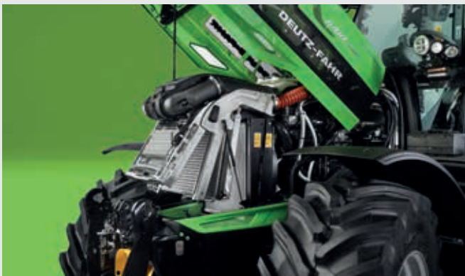
↑ Aluminium-Kühlsystem des 6160.4 - 6190 mit Einhand-Zugangshebel und langlebigen Powercore-Luftfilter mit Zyklon-Vorreinigungssystem.
