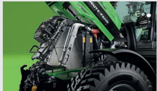
↑ Aluminium-Kühlsystem des 6210 und 6230 mit Einhand-Zugangshebel und Powercore-Luftfilter mit optionalem Zyklon-Vorreinigungssystem.
