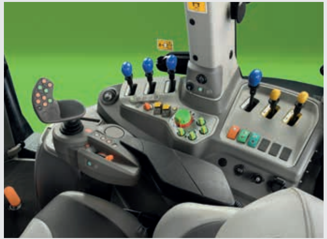
Die MaxiVision-Kabineausstattung mit vollmechanischen Hecksteuerventilen ist für Powershift- (großes Bild) und RCshift- (Bild oben) Modelle erhältlich.
