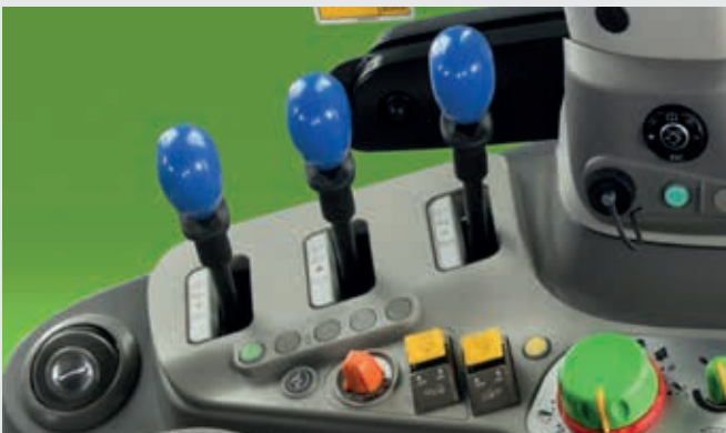
↑ Bis zu 4 mechanische Steuerventile mit ergonomischer Einhebelsteuerung.
