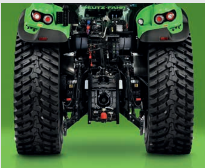
↑ Heckkraftheber mit bis zu 9.700 kg Hubkraft.
