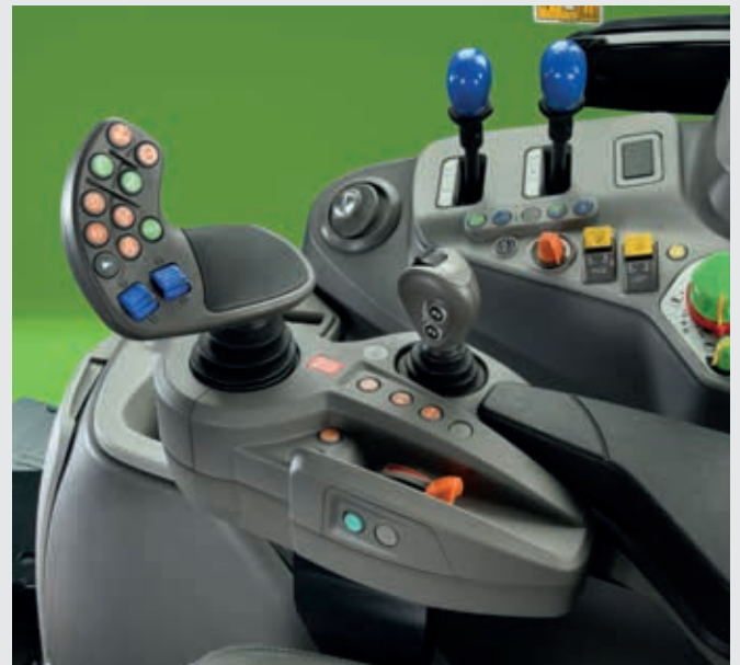
↑ Mit den Daumenrädern am MaxCom-Joystick und zwei mechanischen Bedienhebeln werden die hinteren Steuerventile gesteuert, während der Kreuzhebel zur Steuerung des Frontladers verwendet werden kann.
