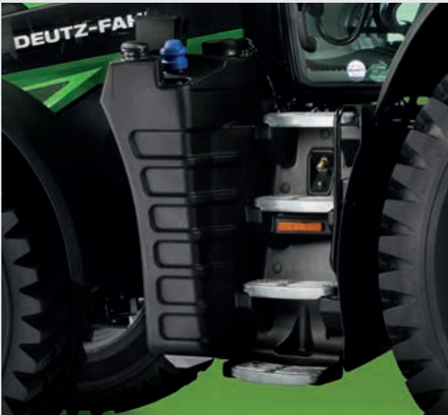
↑ Bis zu 410 l Kraftstofftank für längste Einsatzzeiten.
