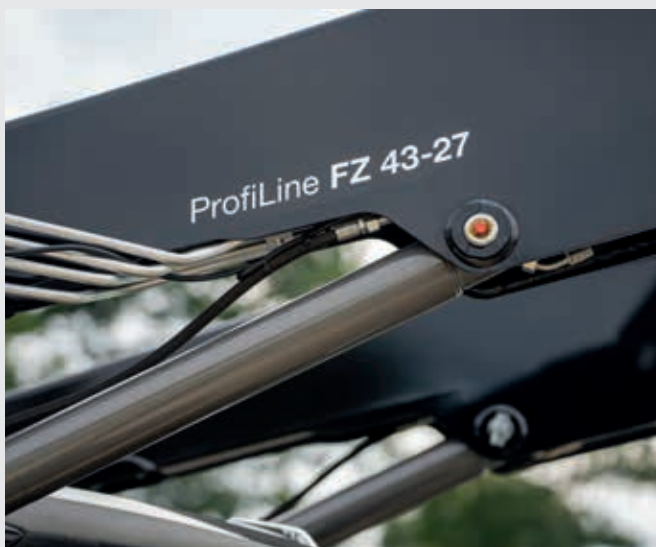
↑ Bei den neuen ProfiLine-Frontladern sind alle Hydraulikleitungen geschützt in der Balkenschiene integriert, so dass der Fahrer freie Sicht hat.
