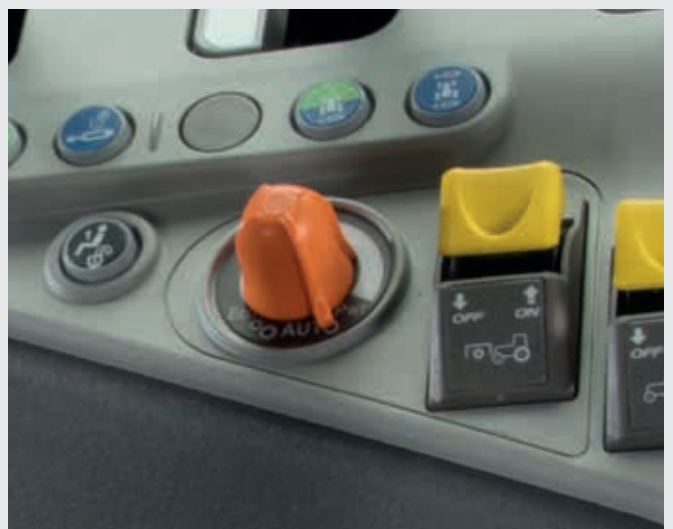
↑ Einfach und intuitiv – mit dem Eco/Power-Drehrad kann der Fahrer das APS (Automatic PowerShift)-Schaltverhalten ändern.
