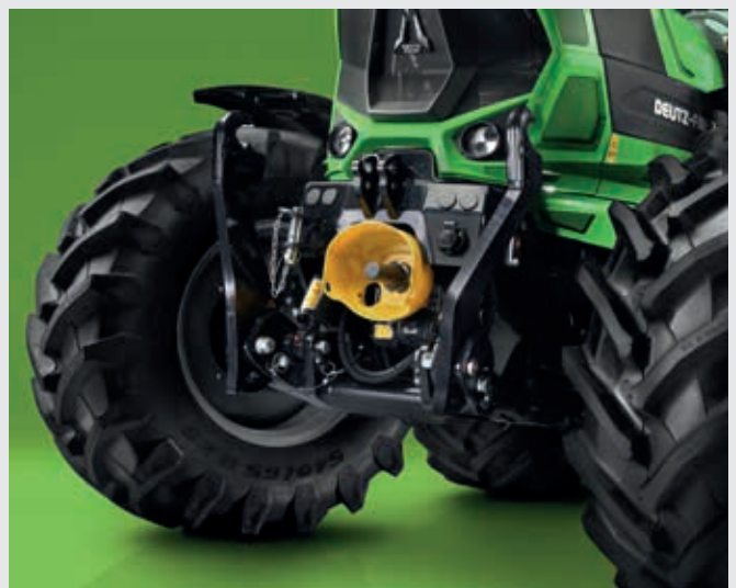
↑ Neuer Frontkraftheber „efficient“ mit bis zu 3.800 kg Hubkraft und optionale 1000-Frontzapfwelle.
