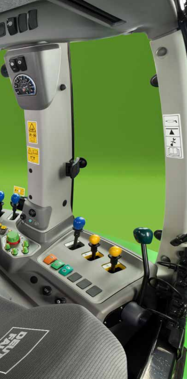
Die MaxiVision-Kabineausstattung mit vollmechanischen Hecksteuerventilen ist für Powershift- (großes Bild) und RCshift- (Bild oben) Modelle erhältlich.
