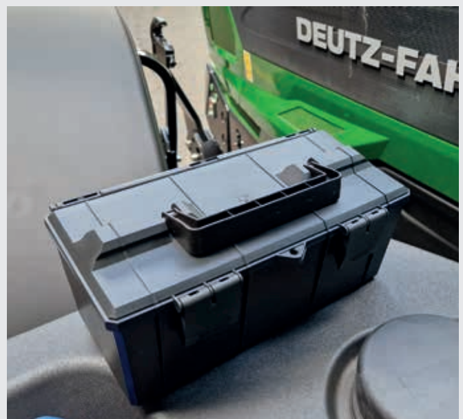
↑ Staukasten oberhalb des Kraftstofftanks auf der linken Seite für Luftschlauch und Luftpistole.
