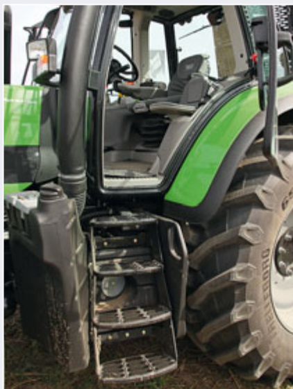
Der neu gestaltete Aufstieg hat jetzt vier statt drei Trittstufen. Die Verkleidungen in der Kabine machen einen höherwertigen Eindruck, und der Beifahrersitz ist gepolstert.
