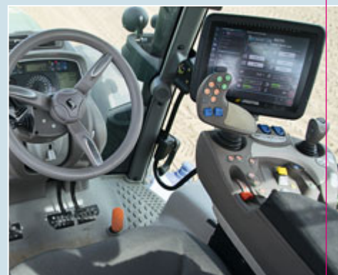
Die Bedienarmlehne und der Multifunktionsgriff wurden für die Serie 7 komplett neu gestaltet. Der große Bildschirm ist leider nicht blendfrei.
