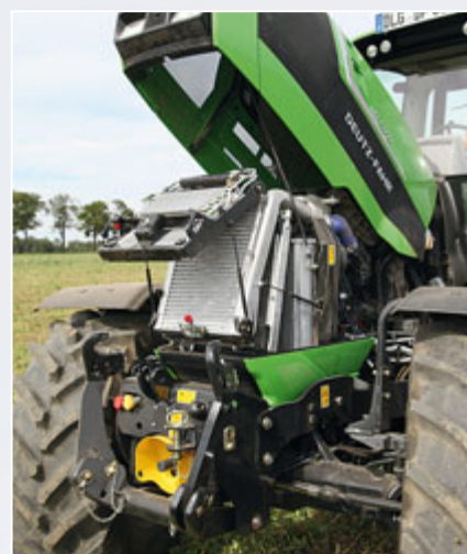
Das Kühlerpaket lässt sich – dank Gasdruckdämpferunterstützung – sehr einfach aufstellen.
