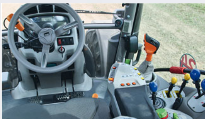
Die Doppel-H-Schaltung (mit neuem Hebel) steht schräg zur Fahrtrichtung. Neben „Speedmatching“ gibt es jetzt „SenseShift“ für einen möglichst ruckfreien Wechsel der Lastschaltstufen. Die Aggressivität der Wendeschaltung ist auf dem Hebel unter dem Lenkrad einstellbar.
