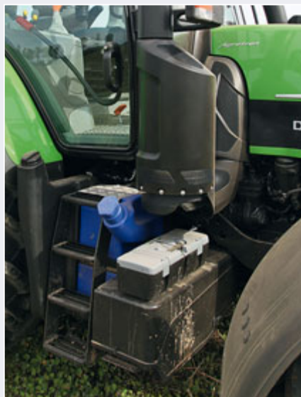
Der 35-l-„AdBlue“-Tank kann nur rechts befüllt werden, der 300-l-Dieseltank dagegen auf beiden Seiten. Der SCR-Katalysator sitzt unten in dem verdickten Auspuff.
