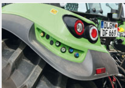
Die neuen Kotflügel gibt es mit verschiedenen Verbreiterungen und integrierter Bedienung für Hubwerk, Hydraulik und Zapfwelle.
