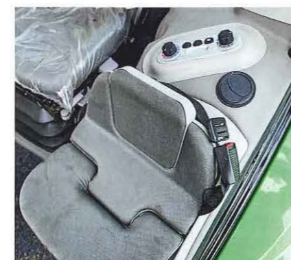
Die Klimaanlage ist leistungsfähiger geworden, und die Bedienknöpfe sind jetzt stabiler. Der Beifahrersitz hat aber leider noch immer keinen Automatikgurt, und das Gurtschloss hängt noch immer in der Tür.
