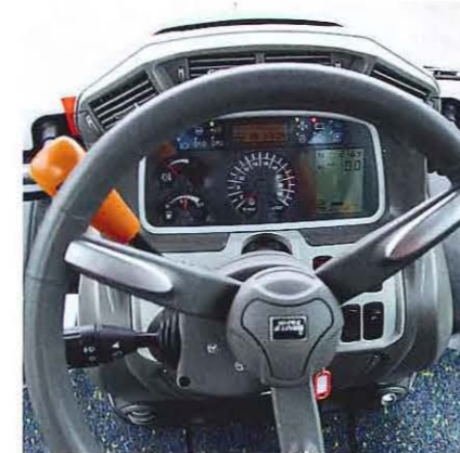
Die neue Frontkonsole erkennt man an den neu gestalteten Luftdüsen rundum, die auch dicht schließen.
