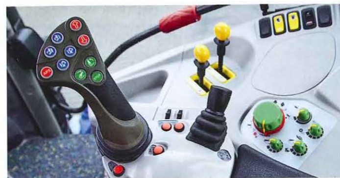
Der neue „PowerComS“ ist sehr viel ergonomischer und schaltet jetzt auch die Gänge. Wahlweise gibt es einen iMonitor in der Konsole.
