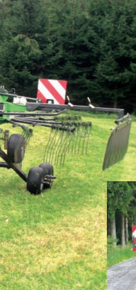
Mit abgenommenen Zinkenträgern beträgt die Transportbreite nur 2,45 m.
