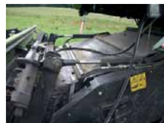
Die beiden Zylinder neigen das Schneidwerk nach vorne. Bei liegendem Getreide ist das von Vorteil.
