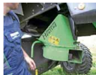
Spreuverteiler von Heuling sind jetzt im Angebot. Ihr Antrieb erfolgt über Keilriemen von der Schüttlerwelle.
