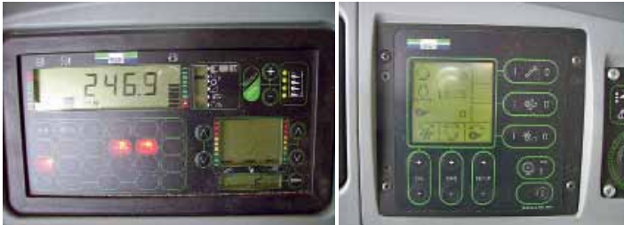
In der rechten Seitenkonsole sind wichtige Bedienelemente zusammengefasst. Der Bordrechner (li.) informiert über den allgemeinen Maschinenzustand. Die Commander Control 2000 überwacht das Dreschsystem.
