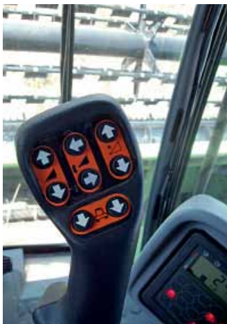
Mit dem Joystick lässt sich das Schneidwerk bedienen. Die Stellung in Rückwärtsfahrt ist unbequem.
