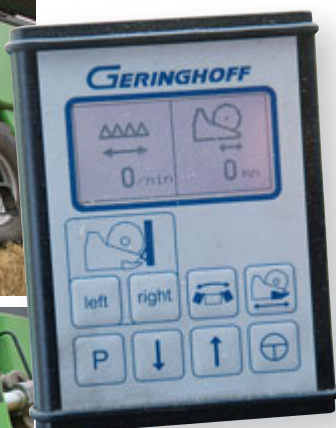
Per Knopfdruck am separaten Terminal in der Kabine lässt sich der Tisch (auch zum Rapsdrusch) um 50 cm ausschleiben. Die aktuelle Position wird auf dem Display digital angezeigt.
