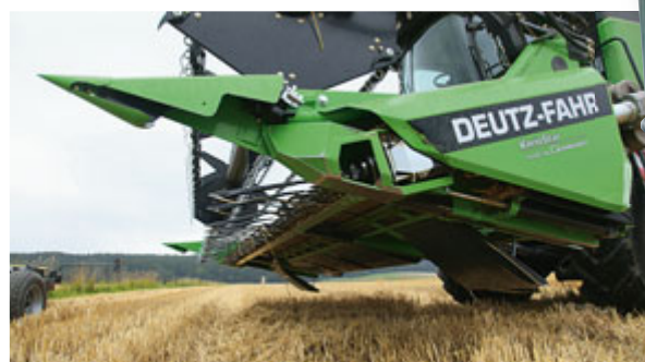
Per Knopfdruck am separaten Terminal in der Kabine lässt sich der Tisch (auch zum Rapsdrusch) um 50 cm ausschleiben. Die aktuelle Position wird auf dem Display digital angezeigt.
