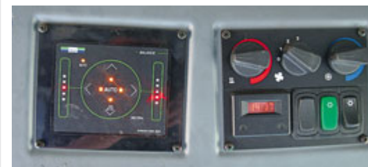
Die Bedienung gibt keine Rätsel auf, der Joystick ist auch nach Jahren noch praxistauglich, hier fehlt nur die Schaltung der Entleerschnelle. Das „Balance“-System funktionierte sehr gut. Ein dreistufiges Gebläse und eine unregelmäßige Klimaanlage sind nicht der neuste technische Stand, funktionieren aber.
