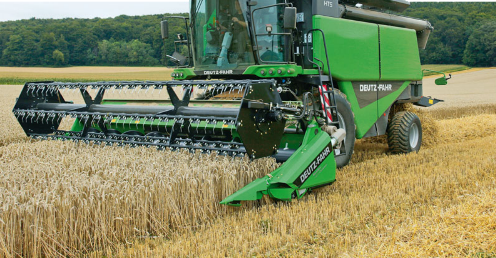
Der 6060 HTS von Deutz-Fahr mit 5 Schüttlern und 250 PS hat sich im Test mit Korndurchsätzen von bis zu 34 t/h sehr gut geschlagen. Fotos: Tovornik, Wilmer
