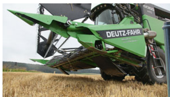
Das „Vario-Star“-Schneidwerk von Geringhoff hat keine Riemen oder Ketten. Die Schnecke wird per Welle angetrieben, Messerbalken und Haspel hydraulisch. Der 5,50 m breite Vorsatz bringt allerdings stolze 2 470 kg auf die Waage.
