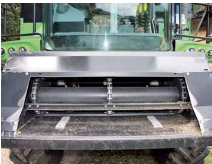
Der Schrägförderer arbeitet mit durchgehenden Leisten. Die vordere Einzugschwelle kann für den Maisdrusch höher gestellt werden.
