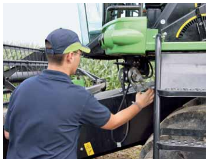
Den Multikuppler gibt es optional – für 980 Euro Aufpreis. Er verbindet allerdings nur die Hydraulik.
