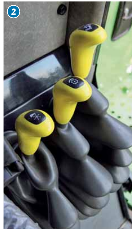
1 Der CCM-Bordinformator ist für diese Leistungsklasse ausreichend. Hier ist auch die Maschinenüberwachung integriert. 2 Schneidwerk, Dreschwerk und Abtankrohr werden mit Hebeln links vom Fahrersitz zu- und abgeschaltet.
