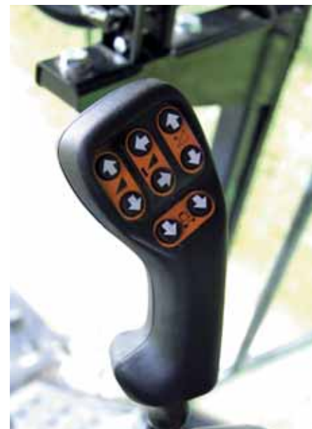
Die wichtigsten Schneidwerksfunktionen lassen sich mit dem CommanderStick am Fahrerhebel bedienen. Die Führungskulisse für den Fahrtrichtungswechsel ist etwas ungewohnt.
