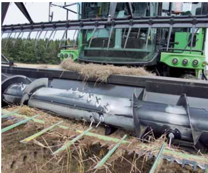
Die spiralförmig angeordneten Finger am Einzug arbeiten in unserem Testeinsatz noch etwas zu aggressiv.
