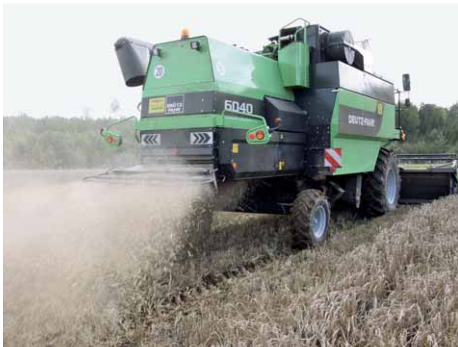
Die Arbeitsqualität des Strohhäckslers (48 Messer) kann sich sehen lassen. Die Leitbleche lassen sich bei Seitenwind aber nicht von der Kabine aus verstellen.
