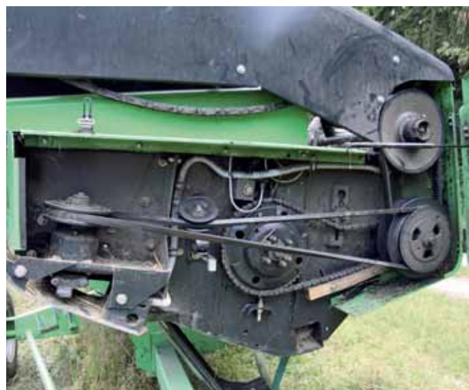
Ein Planetensatz treibt die wechselseitig geschraubten Messer an. Das sorgt für einen ruhigen Lauf und einen sauberen Schnitt.
