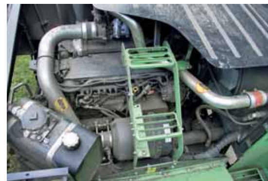
Der 6-l-Commonrail-Motor ist etwas verbaut – schlecht für Wartungsarbeiten. Er gibt seine Kraft an beiden Seiten an die Keilriemen ab.
