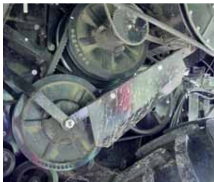
Der Trommelvariator ist nach oben versetzt. Das schafft Platz für die Vorderräder. Der 6040 baut dadurch schmal.
