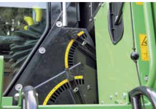
Links von der Kabine werden von Hand die Korbastände verstellt. Das geht folglich nur, wenn der Mähdrescher steht.
