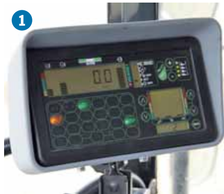
1 Der CCM-Bordinformator ist für diese Leistungsklasse ausreichend. Hier ist auch die Maschinenüberwachung integriert. 2 Schneidwerk, Dreschwerk und Abtankrohr werden mit Hebeln links vom Fahrersitz zu- und abgeschaltet.
