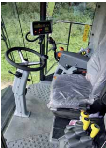
In der Kabine geht es eher beengt zu. Einen Beifahrersitz gibt es nicht. Der Kabinenboden sollte besser gegen Trommelgeräusche isoliert werden.
