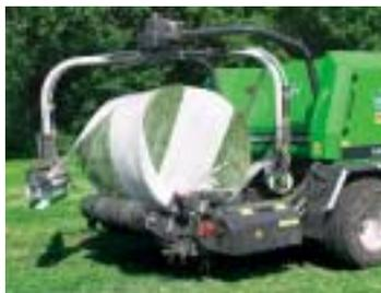
Danach bleibt der Satellitenarm diagonal über dem sich drehenden Ballen stehen. Der Vorstrecker wird um 90° geschwenkt und wickelt zwei Lagen um die Ballenkanten.
