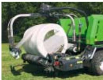
Jetzt schwenkt der Satellitenarm über die Mitte des Ballens und legt zwei Folienlagen auf die zylindrische Fläche des Ballens.
