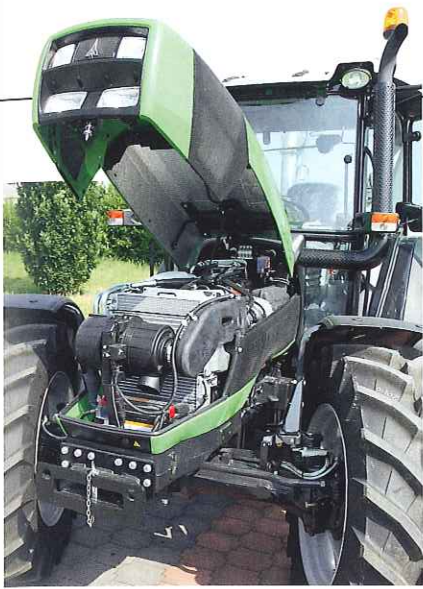
Unter der Haube arbeitet der 4-l-Deutz. Die Vorderachse von Same hat serienmäßig separate Bremsen, eine Federung gibt es aber nicht.
